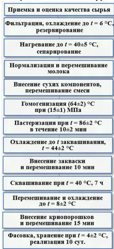
Рисунок 15 – Технологическая схема производства ацидофилина с криопорошком
