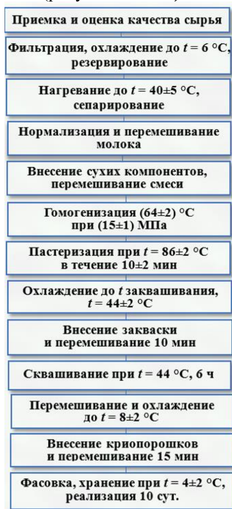
Рисунок 16 – Технологическая схема производства биоюгурта с криопорошком
